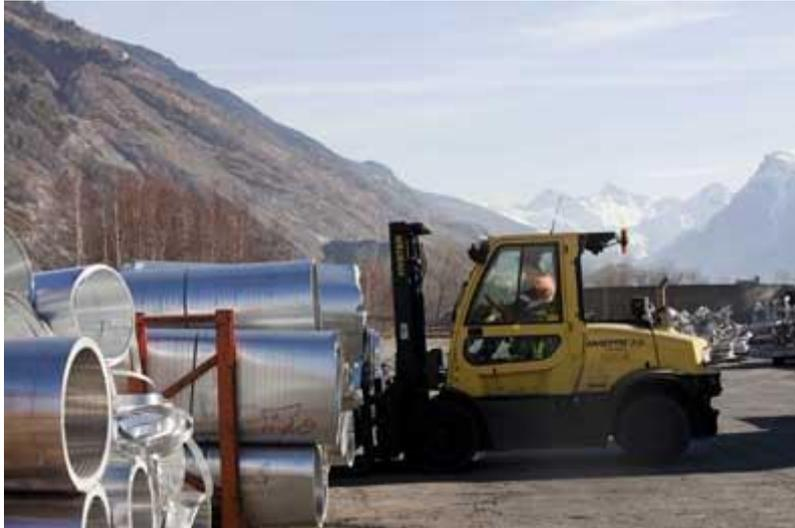
*Fehlerhafte Rollen aus dem Walzwerk in Sierre werden erneut eingeschmolzen.*
